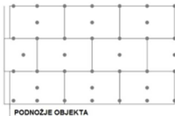
3 pričvrsnice/ploči ili 5 kom/m 2 fasade
