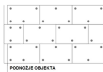
3 pričvrsnice/ploča ili 5 kom/m 2 fasade – W shema
