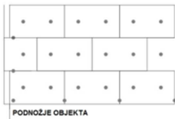
2 pričvrsnice/ploči ili 3-4 kom/m 2 fasade
